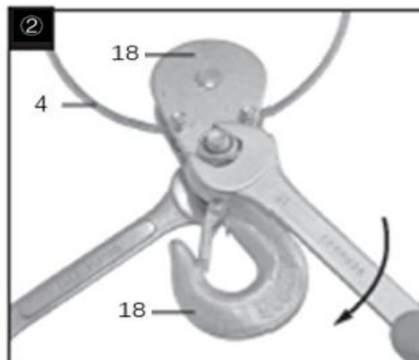
Hängen Sie dazu die Umlenkrolle in das Seil ein (Abbildung 1) und montieren Sie den Lasthaken entsprechend. Ziehen Sie die Halteschraube mit zwei Schraubenschlüssel fest (siehe Abbildung 2).
